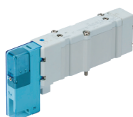
Électro distributeur 5/2 et 2x3/2 avec tiroir à rappel ressort Série SY-X350
