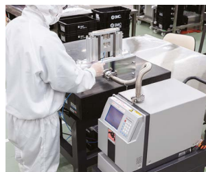
Prove di trafilamento con elio
