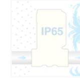
Schutzart IP65 oder höher (staubdichte, strahlwassergeschützte Ausführung)
