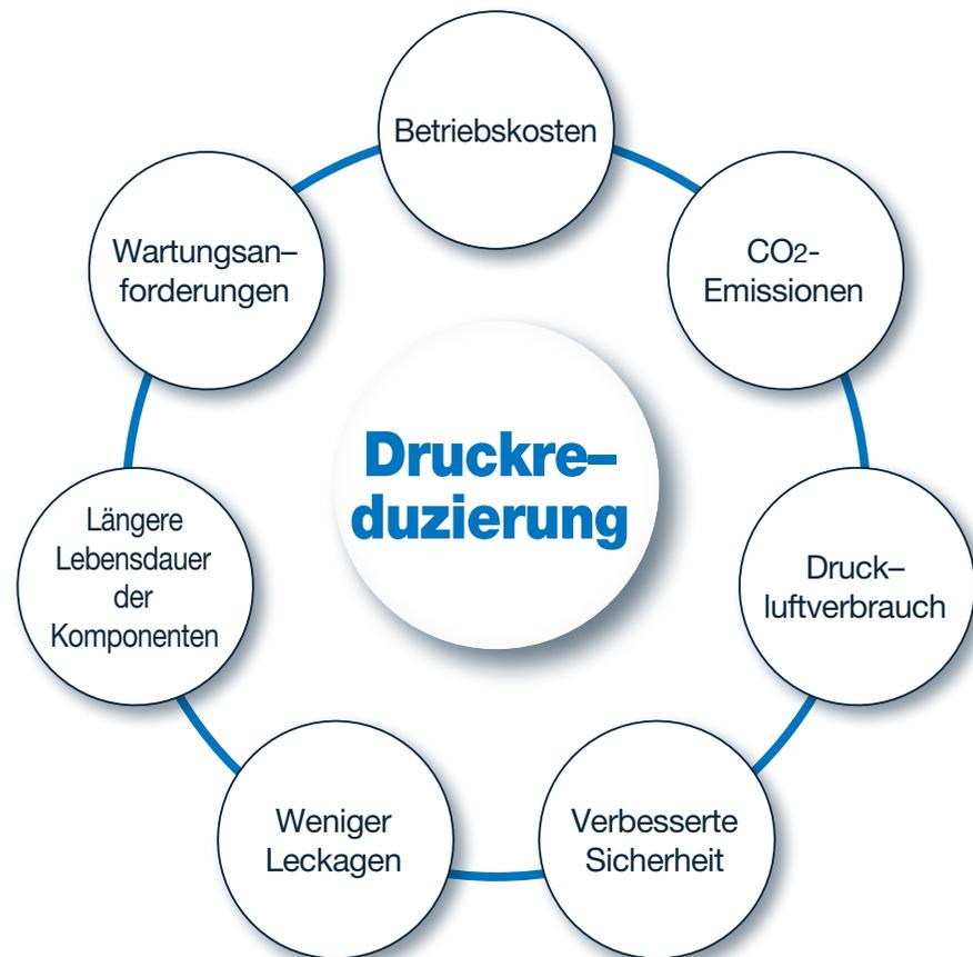
Die Reduzierung des Wartungsaufwands und die Minimierung des Ausfallrisikos setzen eine Optimierung der Betriebsbedingungen Ihres Systems voraus. Eine der effektivsten Strategien ist die **Senkung des Betriebsdrucks auf 4 bar**, wodurch die Belastung der Komponenten reduziert, die Lebensdauer der Ausrüstung verlängert und der Energieverbrauch gesenkt wird.
